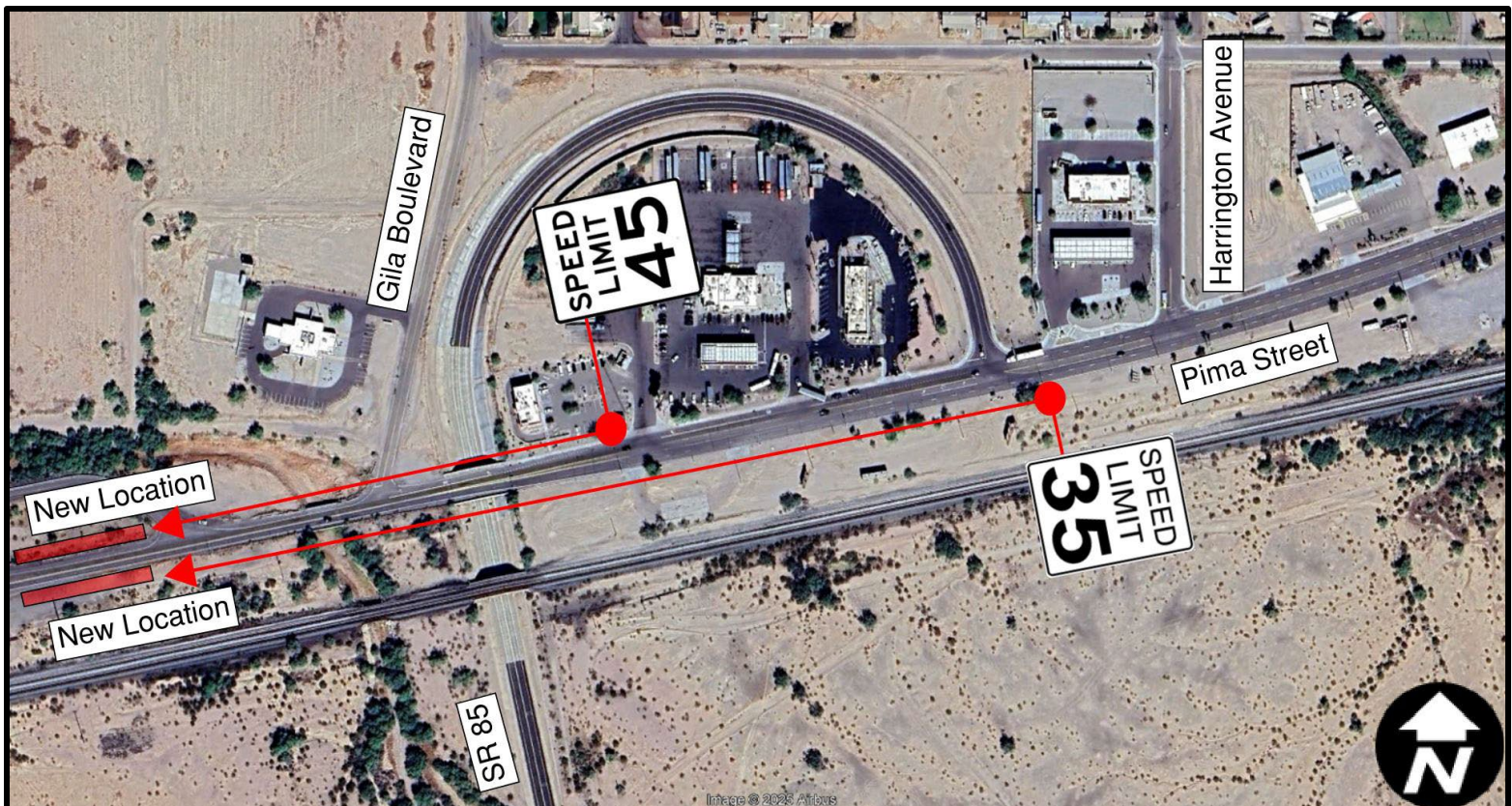
Figura 1 – Reubicación de señales de límite de velocidad
